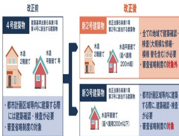
図9 改正後の新2号建築物の位置づけと建築確認・検査対象の見直し、審査省略制度 （出所）国土交通省ホームページ ( https://www.mlit.go.jp )
