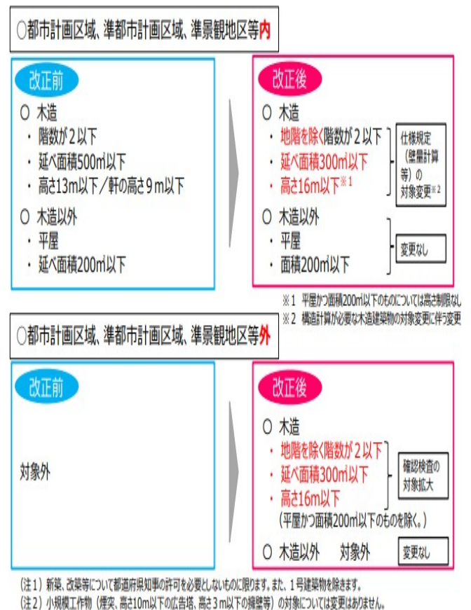
図7 限定特定行政庁の建築主事等の業務範囲（出所）国土交通省ホームページ https://www.mlit.go.jp
