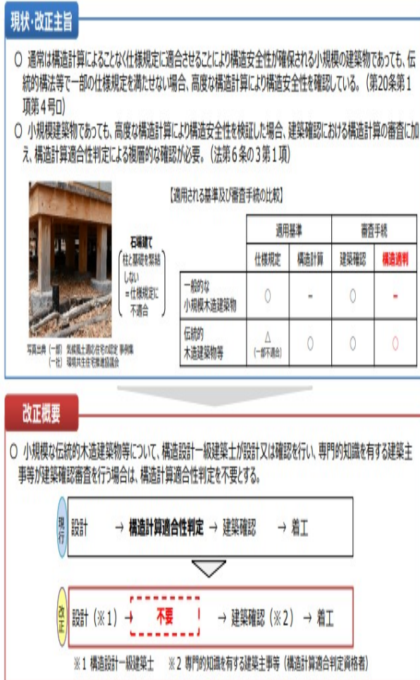
図 8 小規模伝統的木造建築物等に係る構造計算適合性判定の特例の現状・改正趣旨と改正概要
